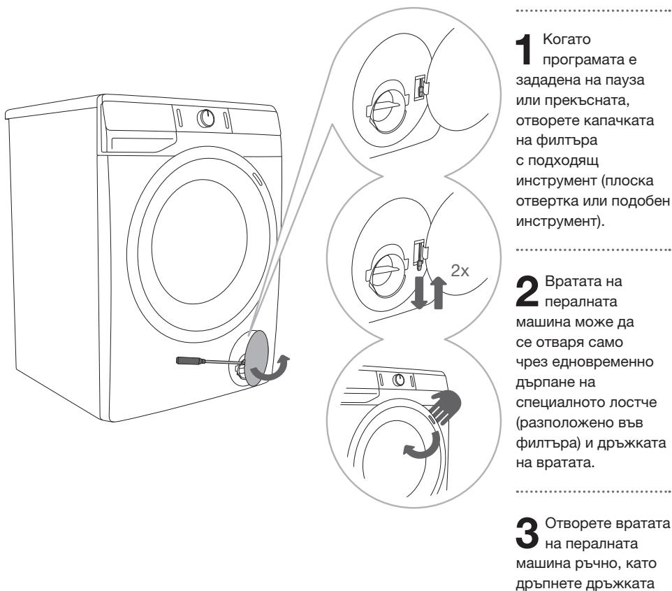
**1** Когато програмата е зададена на пауза или прекъсната, отворете капачката на филтъра с подходящ инструмент (плоска отвертка или подобен инструмент).
